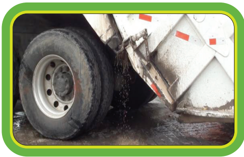
Imagen N.º 33 Camión derramando lixiviados
